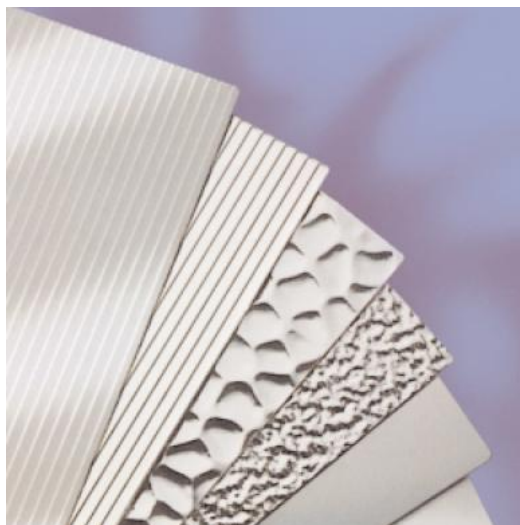
Obr. 4.6: Používané materiály pro reflektory a rozptylovače
